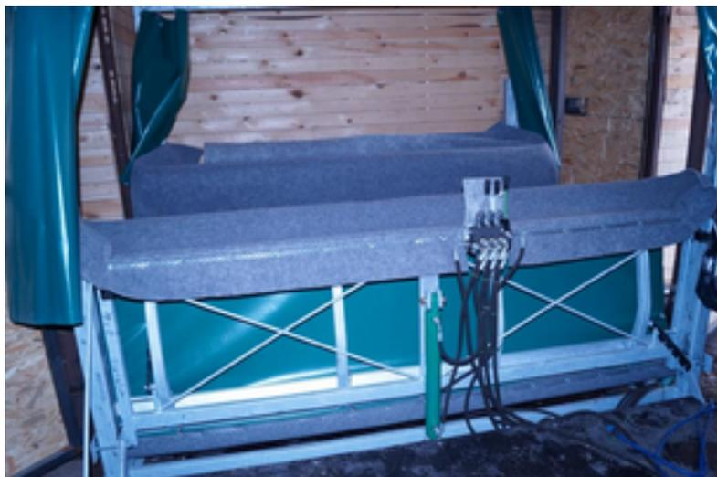
Гидравлический фиксирующий станок производства компании ООО «ДирЛенд» предназначен для обеспечения надежной фиксации благородных оленей при проведении основных операций по уходу за ними: мечение, обезроживание, проведение ветеринарных процедур и др.
